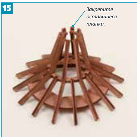
15 При помощи клея для дерева закрепите в вырезы средней и большой деталей остальные длинные вертикальные планки.
